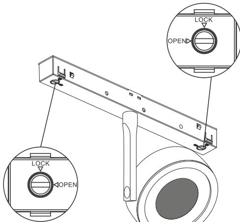
**2** Установите светильник в шинопровод до щелчка
