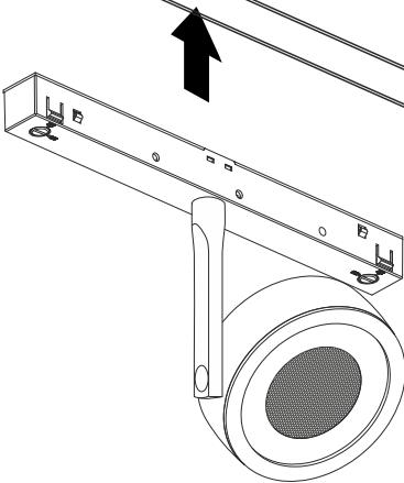
**3** Переведите фиксаторы на адаптере светильника в положение «Lock»
