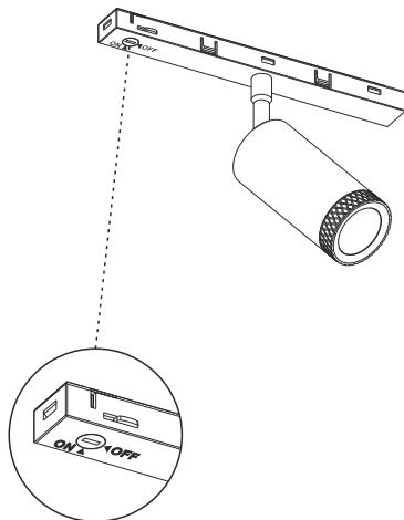
**2** Установите светильник в шинопровод до щелчка
