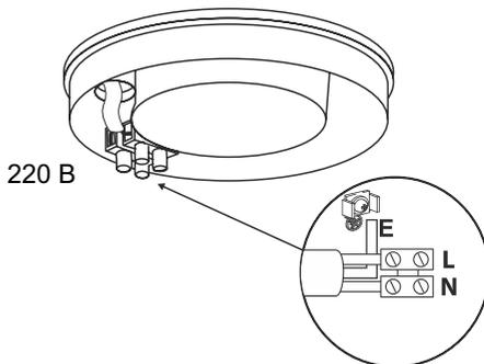
**!** Установка светильника осуществляется при выключенной электрической сети.
