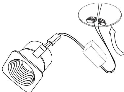
3 Прижмите клипсы к светильнику [1] и установите его в отверстие [2].
