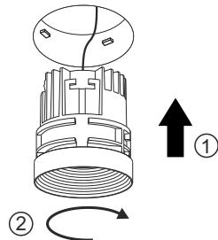
**!** Установка светильника осуществляется при выключеной электрической сети.
