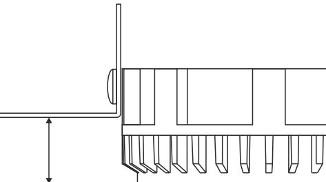
**3** Установите монтажное основание в отверстие и закрепите саморезами.
