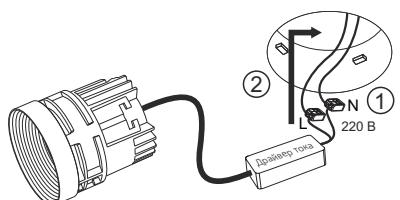
**6** Установите светильник в монтажное основание [1] и зафиксируйте, повернув по часовой стрелке [2].
