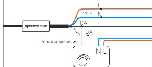
**6** Установка завершена. Отрегулируйте яркость светильника с помощью диммера.
