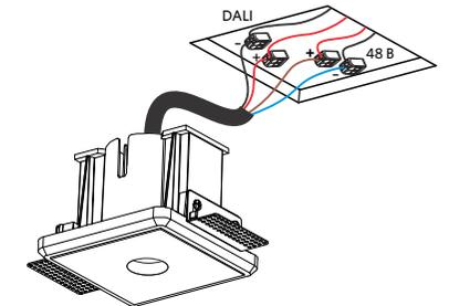
3 Установите монтажное основание в отверстие и закрепите саморезами.
