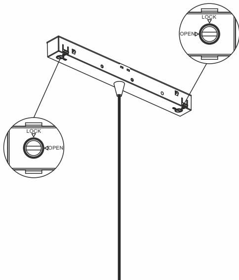
**2** Установите адаптер светильника в шинопровод до щелчка
