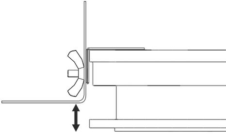
**2** Установите светильник на монтажное основание потолка.
