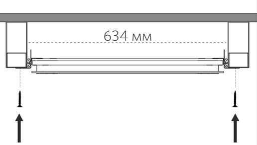
**3** Установите слой гипсокартона с вырезом под светильник.
