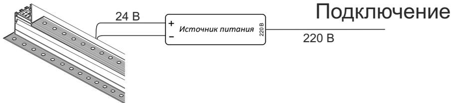
Источник питания устанавливается за пределами корпуса профиля в электромонтажном шкафу
