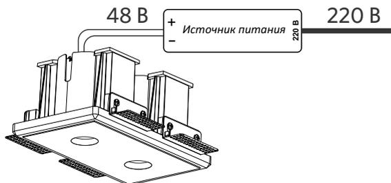
Источник питания устанавливается за пределами корпуса устройства в электромонтажном шкафу
