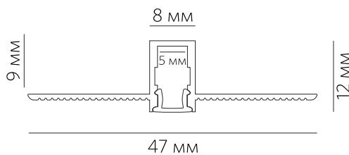
Комплект алюминиевого профиля LINEAR 0812 F предназначен для освещения при помощи интеграции в него светодиодной ленты.
