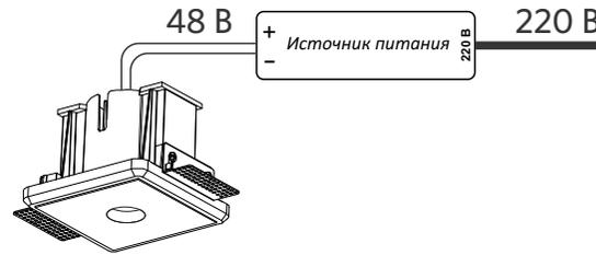
Источник питания устанавливается за пределами корпуса устройства в электромонтажном шкафу
