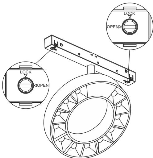
**2** Установите светильник в шинопровод до щелчка
