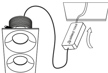
**!** Установка светильника осуществляется при выключенной электрической сети.
