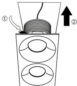
**6** Установка завершена, светильник готов к эксплуатации.
