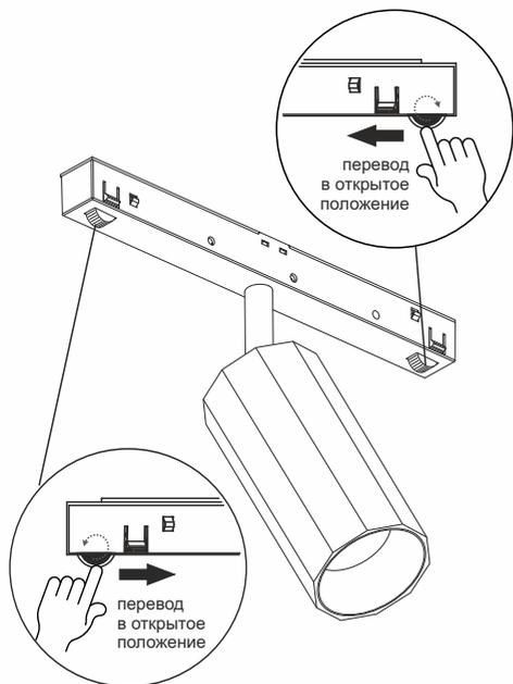
**2** Установите светильник в шинопровод до щелчка
