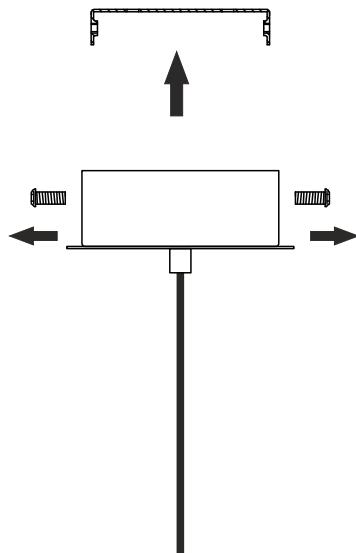
2 Установите крепление на потолке рядом с кабелем питания.
