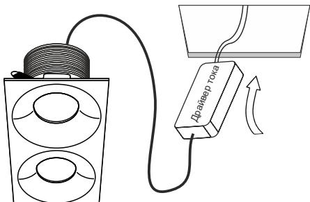
**6** Установка завершена, светильник готов к эксплуатации.
