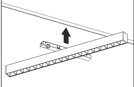
**3** Переведите фиксатор на адаптере светильника в положение «ON»
