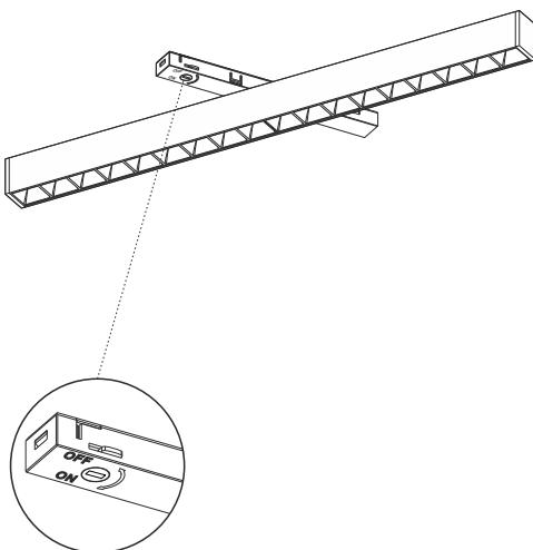
**2** Установите светильник в шинопровод до щелчка
