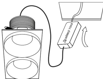
**5** Прижмите клипсы [1] и установите светильник в отверстие [2].
