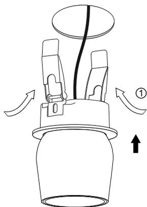
**4** Для регулировки угла наклона прокрутите светильник по часовой стрелке до упора [1], затем отрегулируйте наклон [2].
