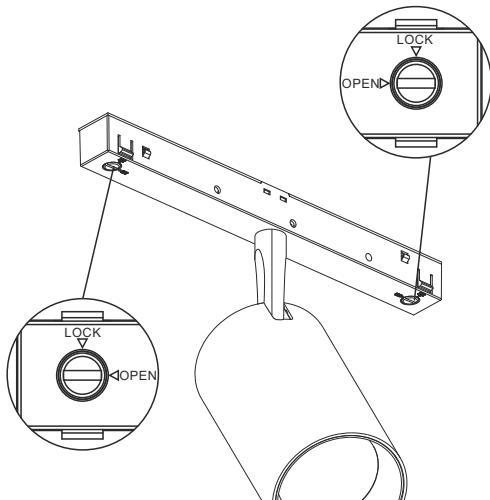
**2** Установите светильник в шинопровод до щелчка
