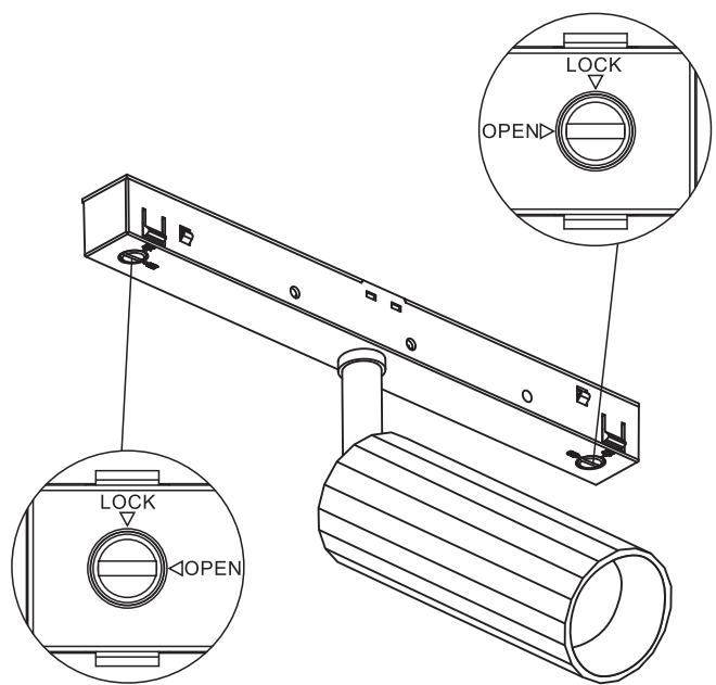
**2** Установите светильник в шинопровод до щелчка
