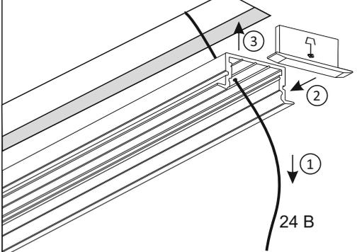
**5** Подключите ленту и наклейте её внутри корпуса профиля [1]. Установите рассеиватель в профиль [2].
