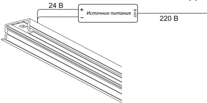
Источник питания устанавливается за пределами корпуса профиля в электромонтажном шкафу, или за потолочным пространством
