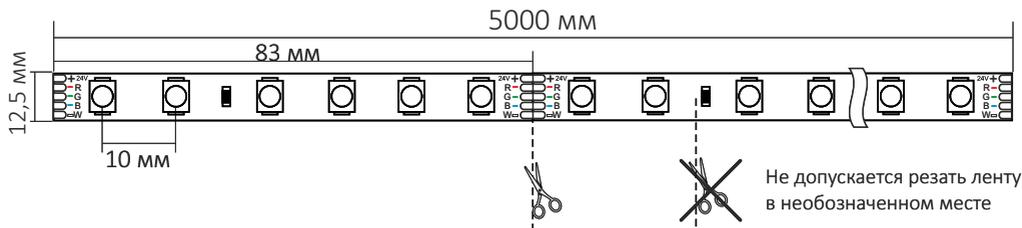
Ленту можно резать строго в указанных местах, между контактными площадками для пайки.
