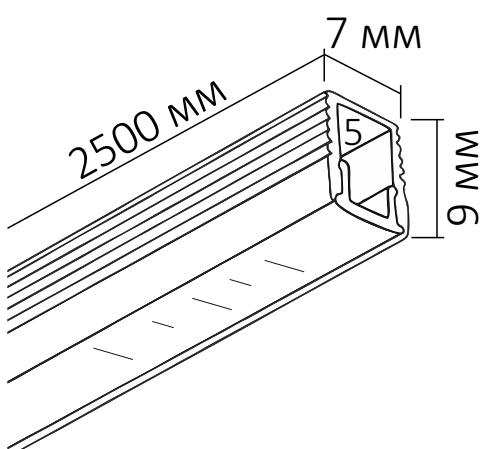
Комплект алюминиевого профиля LINEAR 0709 N предназначен для освещения и подсветки при помощи интеграции в него светодиодной ленты.
