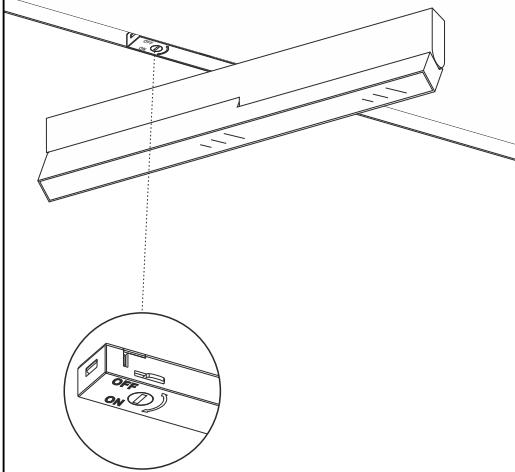
**4** Установка завершена, светильник готов к эксплуатации.
