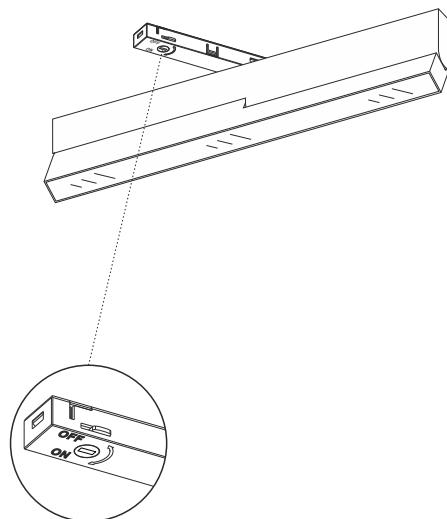
**2** Установите светильник в шинопровод до щелчка
