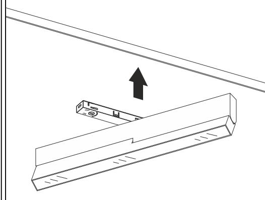
**3** Переведите фиксатор на адаптере светильника в положение «ON»
