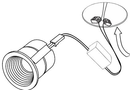
**3** Прижмите клипсы к светильнику [1] и установите его в отверстие [2].
