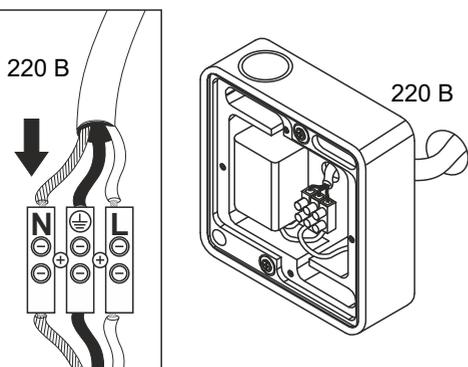
**!** Установка светильника осуществляется при выключенной электрической сети.
