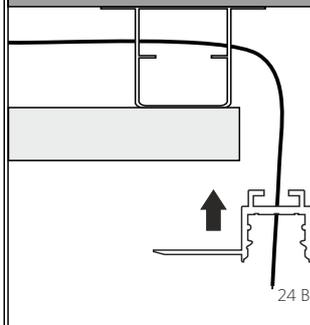
4 Зафиксируйте корпус профиля саморезами.
