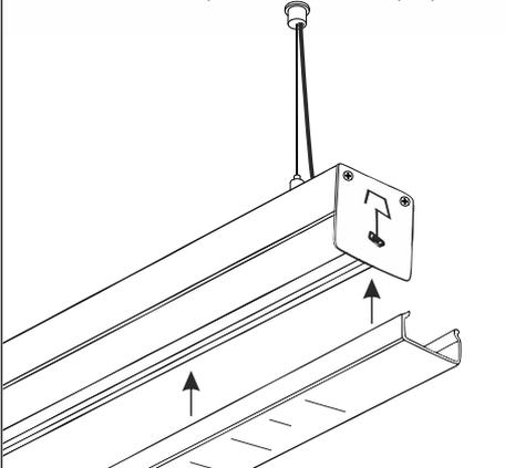
6 Установка завершена, профиль готов к эксплуатации.
