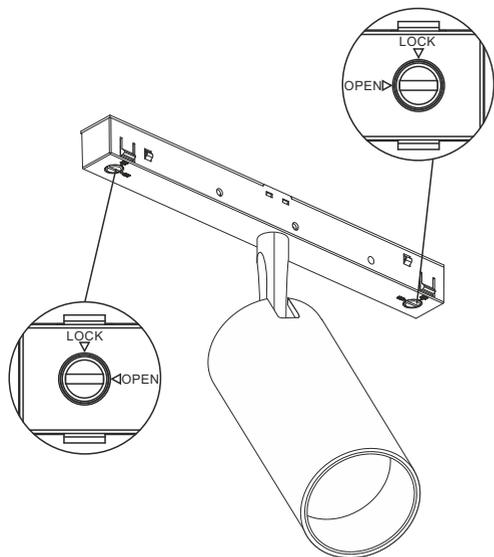
**2** Установите светильник в шинпровод до щелчка
