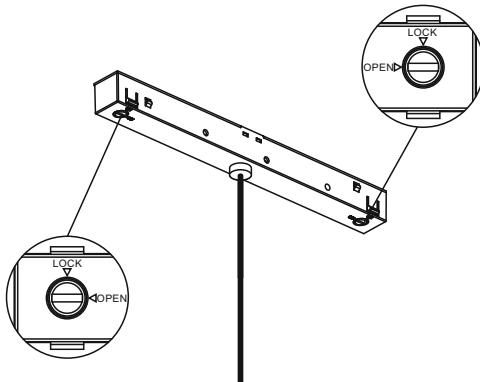
**2** Установите адаптер светильника в шинопровод до щелчка
