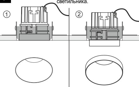
**6** Установите светильник в монтажное основание [1] и зафиксируйте, повернув по часовой стрелке [2].
