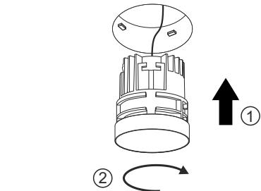
**8** Установка завершена. Отрегулируйте яркость и цветовую температуру светильника с помощью диммера.
