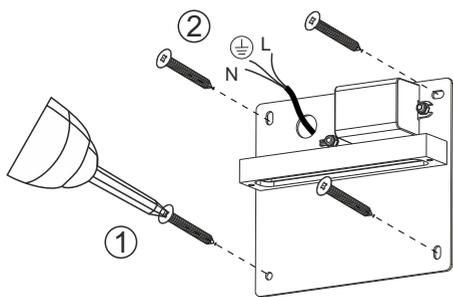
**4** Подключите светильник к сети 220 В с помощью термоусадочных клемм.
