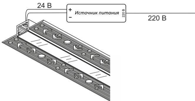
Источник питания устанавливается за пределами корпуса профиля в электромонтажном шкафу
