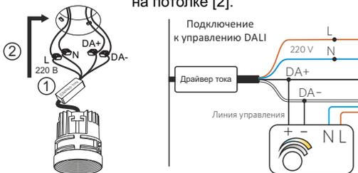
**6** Установите светильник в монтажное основание [1] и зафиксируйте, повернув по часовой стрелке [2].
