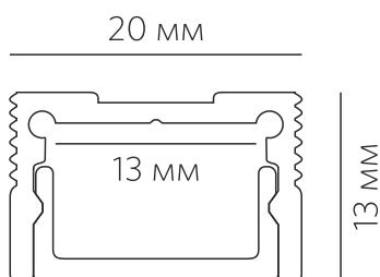
Комплект накладного алюминиевого профиля LINEAR 2013 N предназначен для освещения и подсветки при помощи интеграции в него светодиодной ленты.
