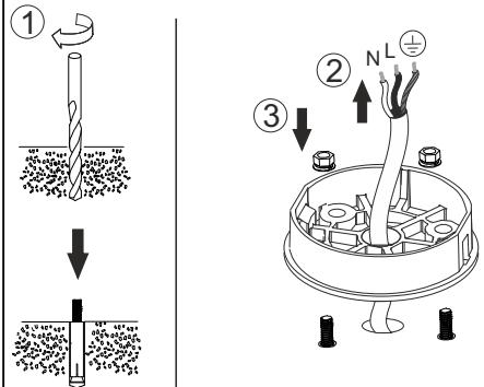
**3** Подключите светильник в сеть 220 В с помощью герметичного коннектора.
