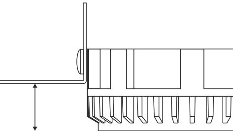
**3** Установите монтажное основание в отверстие и закрепите саморезами.
