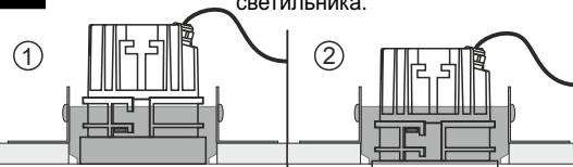
**6** Установите светильник в монтажное основание [1] и зафиксируйте, повернув по часовой стрелке [2].
