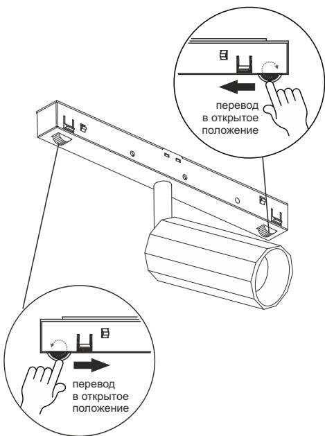
**2** Установите светильник в шинопровод до щелчка
