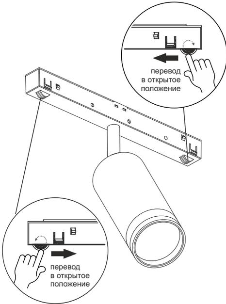
**2** Установите светильник в шинпровод до щелчка
