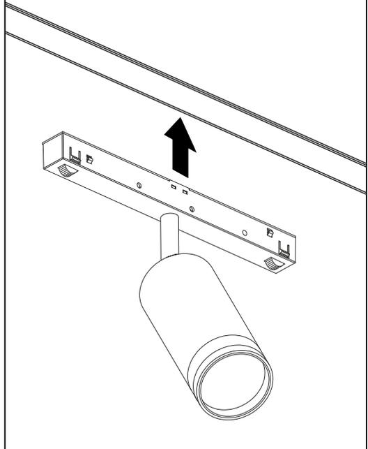
**3** Переведите фиксаторы на адаптере светильника в закрытое положение
