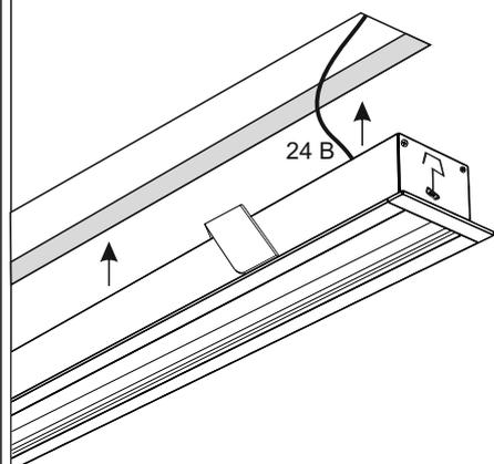
**4** Поверните скобы, закрутив винт до состояния плотного прижатия к поверхности потолка.
