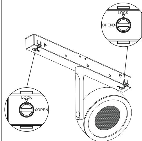
2 Установите светильник в шинопровод до щелчка
