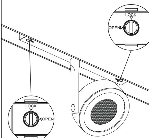
4 Установка завершена, светильник готов к эксплуатации.
