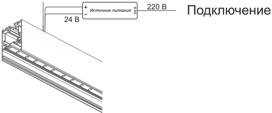
Источник питания устанавливается в корпусе профиля, за потолочным пространством, или в электромонтажном шкафу
