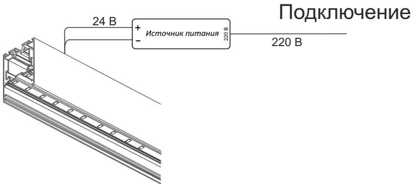
Источник питания устанавливается в корпусе профиля, за потолочным пространством, или в электромонтажном шкафу
