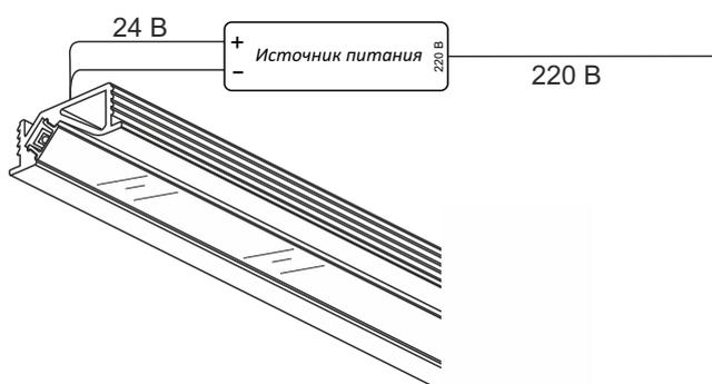
Источник питания устанавливается за пределами корпуса профиля в электромонтажном шкафу, или за потолочным пространством
