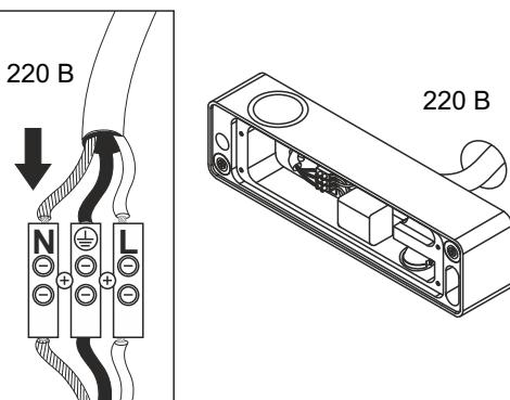
**!** Установка светильника осуществляется при выключеной электрической сети.
