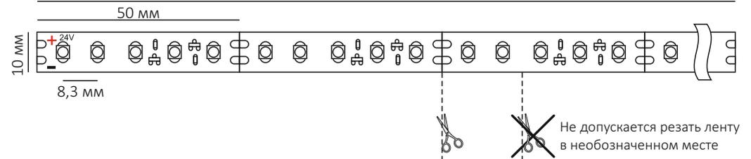
Ленту можно резать строго в указанных местах, между контактными площадками для пайки.
