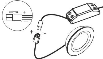
Установка светильника осуществляется при выключеной электрической сети.
