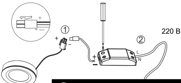
Установка светильника осуществляется при выключеной электрической сети.
