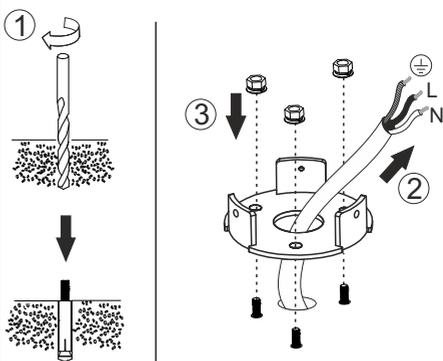
**3** Подключите светильник в сети 220 В с помощью герметичного коннектора.
